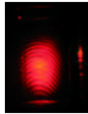
Abbildung 15: Intefferenzmuster des Becherglases bei Füllung mit „Druckluft“
